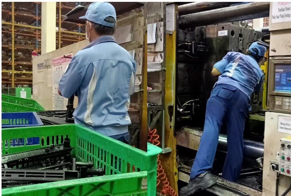
Gambar 3.10 Proses Mengambil Hasil Injeksi dan Pemotongan Bari
