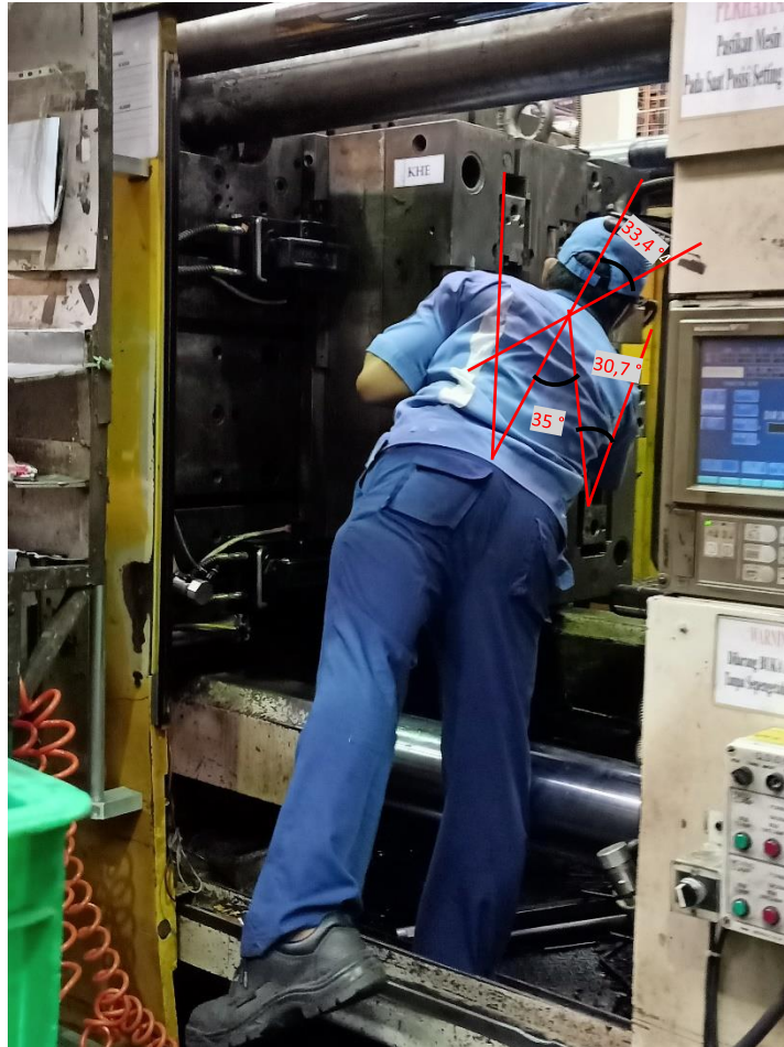
Gambar 3.8 Proses Memasukan Insert Pada Lubang Mold
